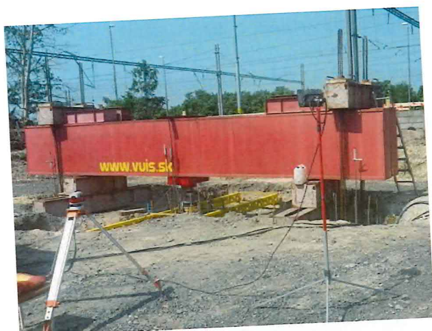
UČS 02, Zaťažovacia skúška pilóty
