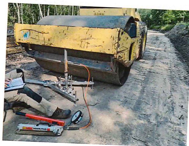
UČS 10, Odkop po zemnú pláň, vykonanie SZS
